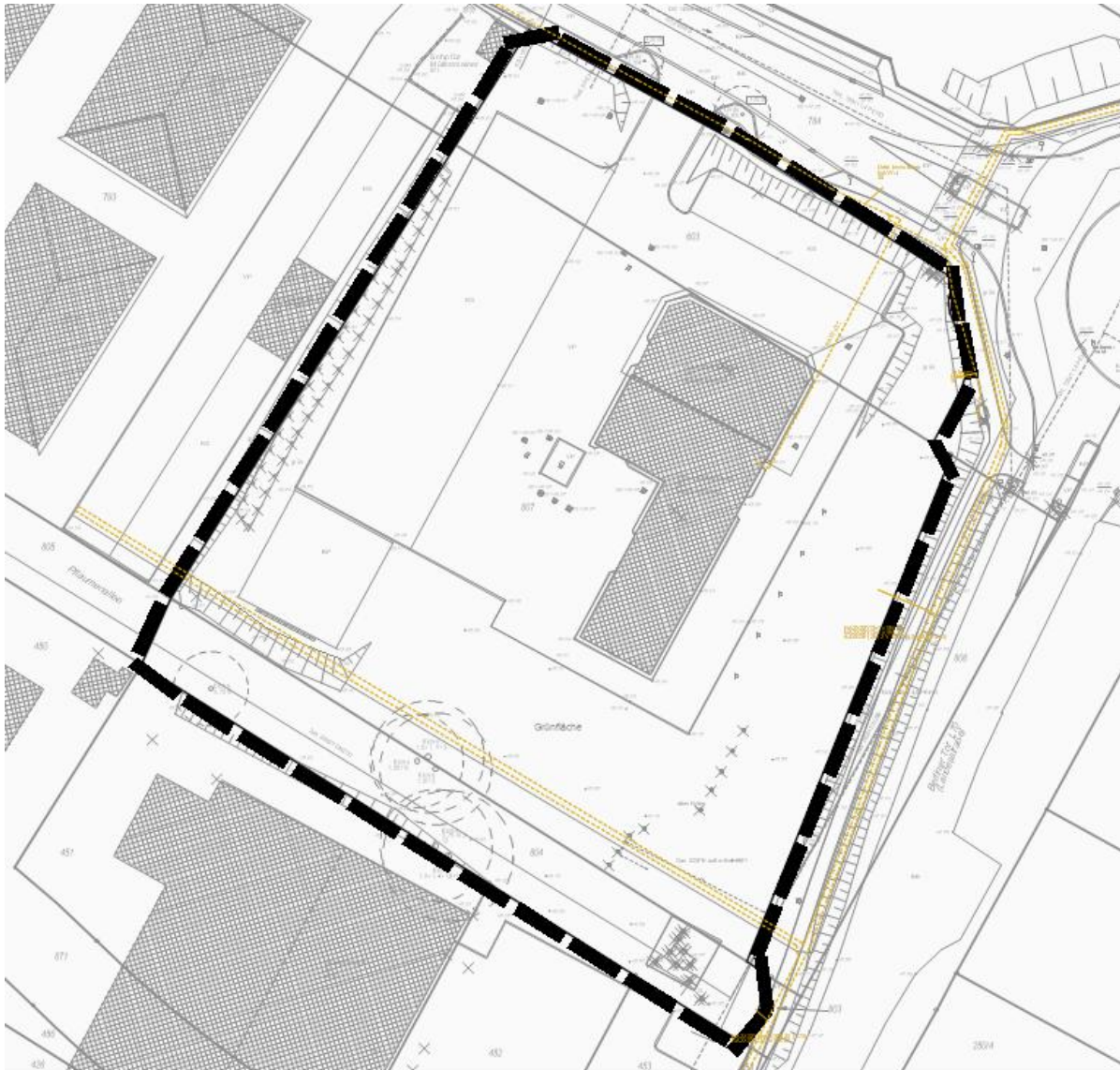
Abb. 4: Lage der Stromleitungen
