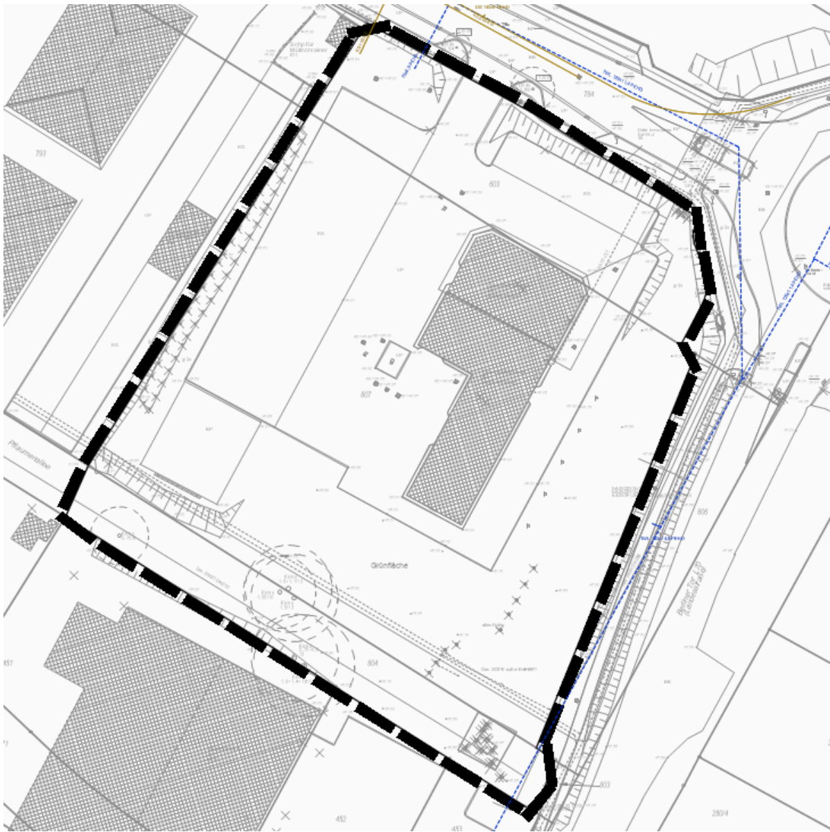
Abb. 2: Lage der Trinkwasserver- und Abwasserentsorgungsleitungen
