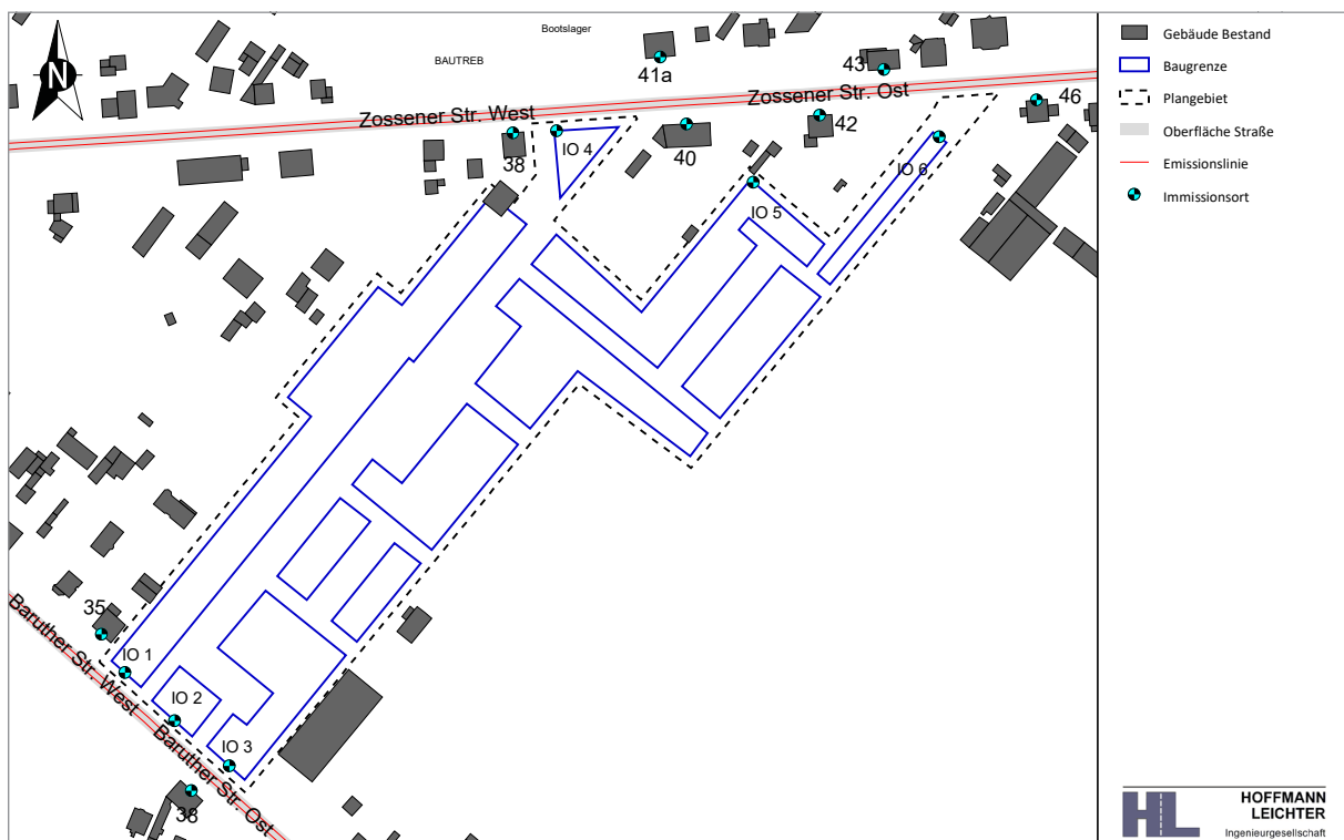
Abbildung 4-3 Lage der Schallquellen zum Verkehrslärm
